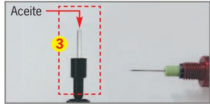
1. Deslice el mandril y el collar sobre el tubo capilar de cristal al que se ha dado forma de aguja.
