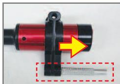
La dirección de los cambios del adaptador universal debido a relaciones de posición con cosas como microscopios y el extremo del Nanoject III.
