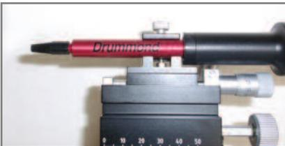
1. Inserte el Nanoject III directamente en el micromanipulador y apriete el tornillo.
