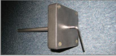
1. Coloque el pilar principal hacia el centro de la placa de acero cuadrada. Apriétela con firmeza desde la parte inferior con una llave Allen.
