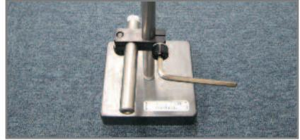
2. Coloque el travesaño corto en el pilar principal como se muestra en el diagrama y apriételo con una llave Allen.
