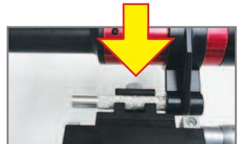
Inserte el adaptador universal en el micromanipulador y apriete el tornillo.
