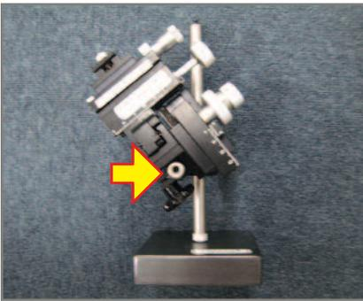
Setzen Sie den Mikromanipulator auf den kurzen Querträger.
