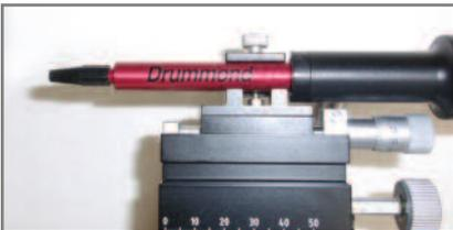
1. Führen Sie den Nanoject III direkt in den Mikromanipulator ein und ziehen Sie die Stellschraube fest.
