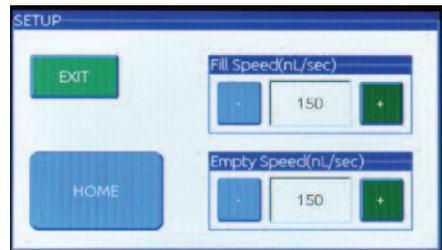
**Hinweis:** Wie bereits erwähnt, haben die Füll - und Entleergeschwindigkeiten in diesem Bildschirm keinen Einfluss auf die Injektionsrate.
