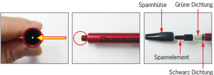
5. Bringen Sie das Aluminiumgehäuse wieder an. Bringen Sie das schwarz Dichtung, die grüne Dichtung, das Spannelement und die Spannhülse wieder an.
