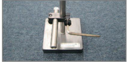
2. Bringen Sie wie in der Abbildung dargestellt den kurzen Querträger am Hauptträger an und ziehen Sie ihn mit einem Inbusschlüssel fest.
