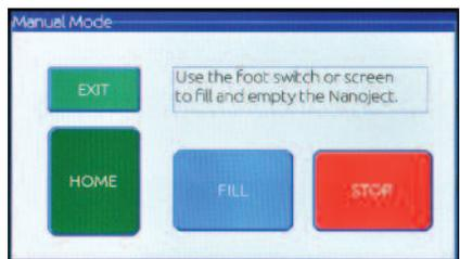
Die Kurzdrukfunktionen wie [**EMPTY**] und [**FILL**] können nicht mit dem Fußschalter ausgeführt werden. Dieselbe Situation liegt vor, wenn Sie die Pedale für Funktionen wie [**EMPTY**] und [**FILL**] fortgesetzt drücken. Wenn Sie den Druck auf das Pedal verringern, stoppt der Motor.
