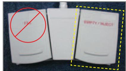
Wenn [INJECT] mit dem Fußschalter verwendet wird, drücken Sie das Pedal bitte so lange, bis der Piepton zu hören ist.
