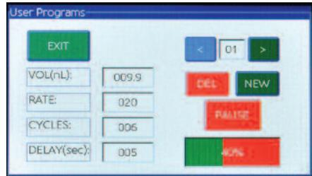
Unter der Schaltfläche [**RUN**] wird in einem Feld die Anzahl der verbleibenden Injektionszyklen im gesamten Programm angezeigt. Der Wert zählt mit dem Fortschritt der Injektionszyklen rückwärts bis Null. Unter diesem Zählerfeld wird in einem weiteren Feld der Prozentwert des restlichen Programms angezeigt. Der Wert zählt mit dem Fortschritt der Injektionszyklen rückwärts bis 0 Prozent.
