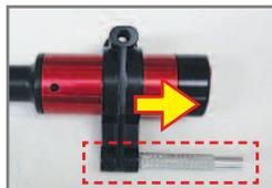
Die Richtung des Universaladapters ändert sich je nach Position von z. B. Mikroskopen sowie dem Endstück des Nanoject III.
