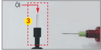
1. Schieben Sie das Spannelement und die Spannhülse auf die Glaskapillare, die in eine Nadelform ausgezogen wurde.
