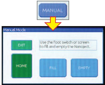
Wenn [ **FILL** ] oder [ **EMPTY** ] gedrückt wurde und Sie den entsprechenden Vorgang stoppen möchten, drücken Sie einfach ein zweites Mal auf dieselbe Schaltflächenposition (die jetzt als [ **STOP** ] angezeigt wird).
